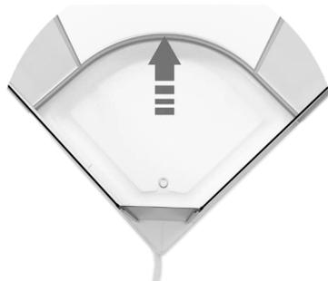
6.6 Закрепите нижний профиль задних стенок 4 с поддоном 15А/ 15Б при помощи саморезов 36 в указанных точках.
